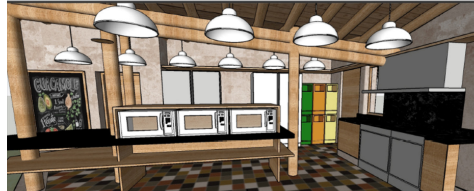
Este sector cuenta con espacios de cocina para guardado, refrigeración y calentamiento de viandas, mesadas y bachas para el lavado de vajilla, depósito de sector cocina, baño accesible y área de separación de residuos.
