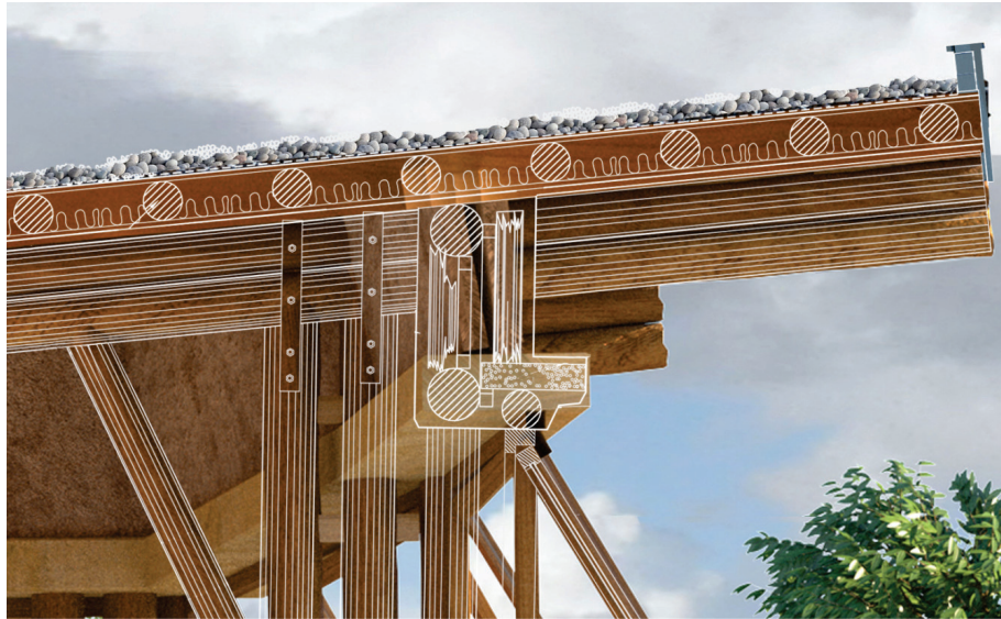
Render del corte de la estructura de la cubierta del salón principal.
