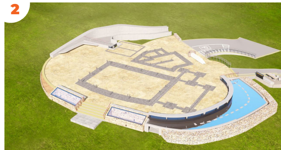
2 Estanque, lechos de piedra, fundaciones y anclajes de columnas.
