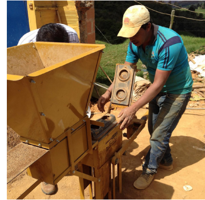
Fabricación de BTC en prensas manuales, simples y dobles.
