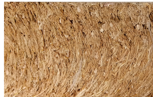
Detalle del panel de rastrojo de trigo picado y prensado.
