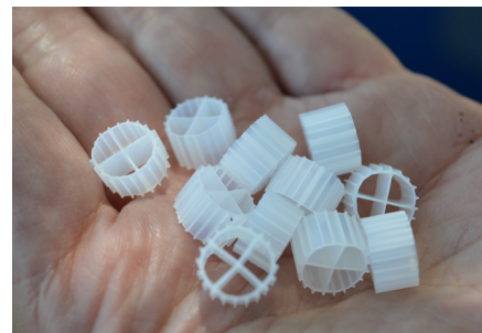
Unidades activas del sistema MBBR.
