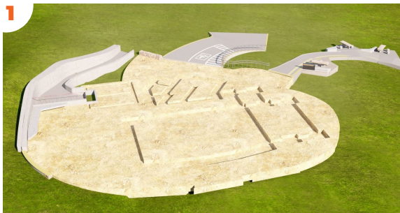
1 Relleno y compactación. Excavación fundaciones.
