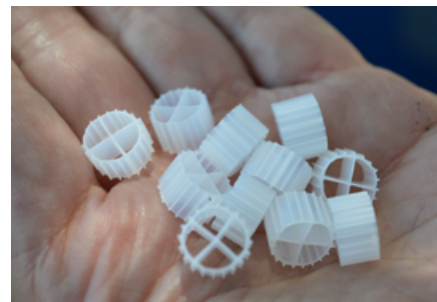
Unidades activas del sistema MBBR.
