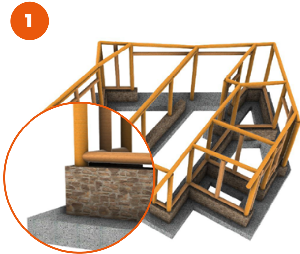
Sobrecimientos y pórticos.
