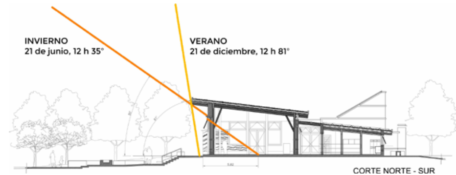
Corte Norte - Sur con asoleamiento en invierno y verano.
