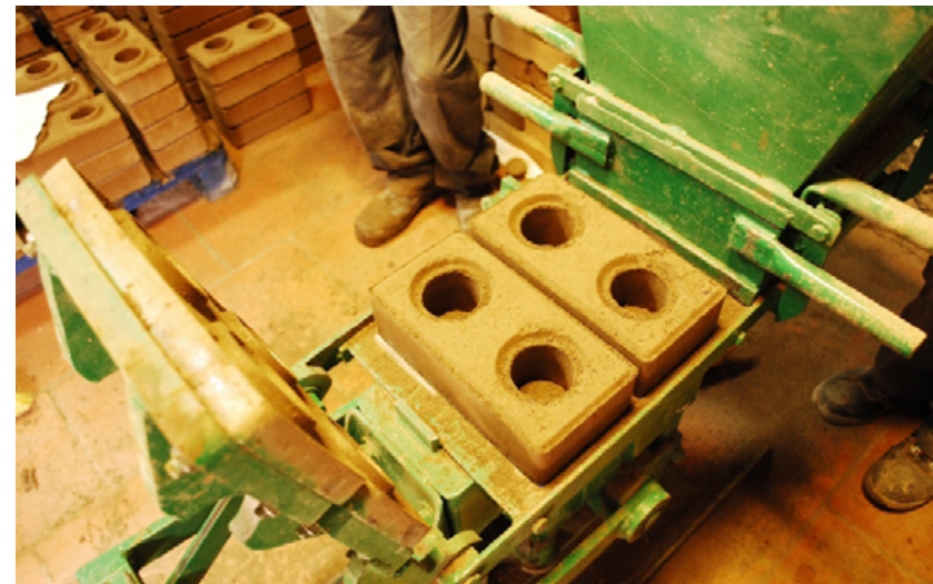
Fabricación de BTC en prensas manuales, simples y dobles.
