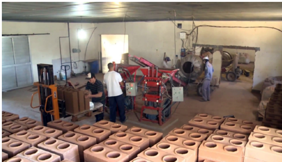
Pequeña unidad productiva con prensa hidráulica.
