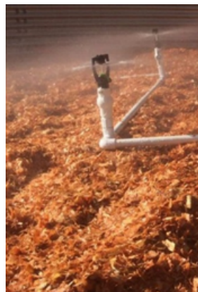
Aspersión de agua residual en el sustrato biológico de lombrices
