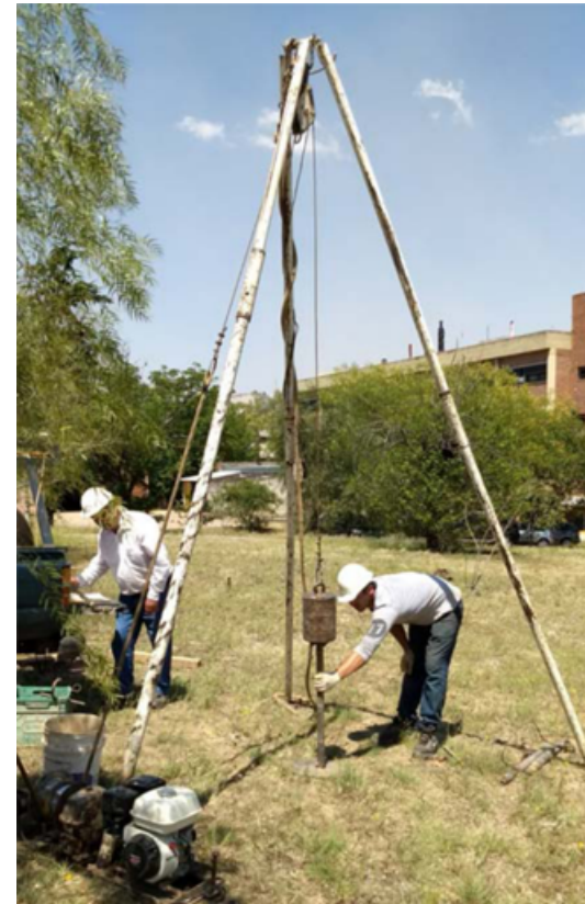
Ensayo de penetración en el predio de INTI donde se implantará el SUME.
