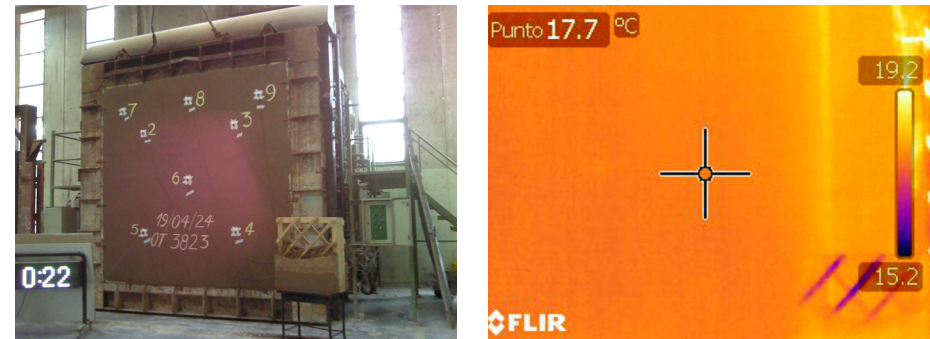
Fotografía e imagen termográfica del muro al iniciar el ensayo.
