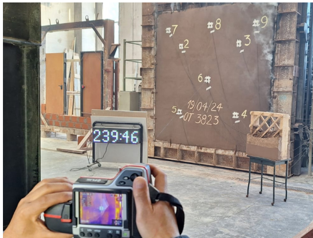
Momento de finalización del ensayo de resistencia al fuego.
