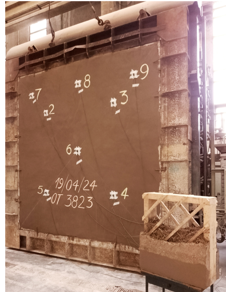
Muro de quincha en la boca del horno, previo al inicio del ensayo. En la cara no expuesta se colocaron sensores de temperatura numerados.
