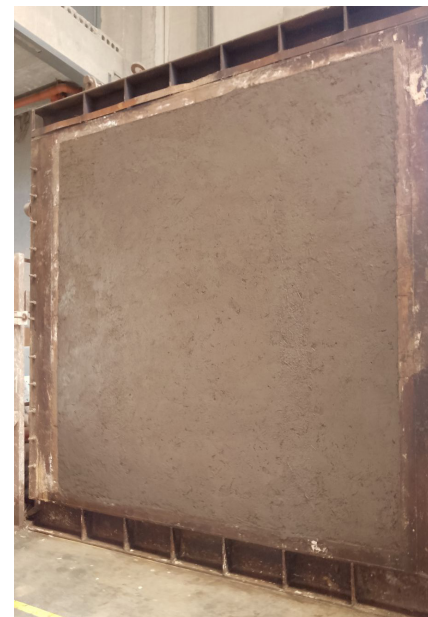
Muro con revoque grueso.
