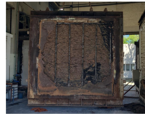
Imagen 11 - Aspecto de la cara expuesta de la muestra una vez finalizado el ensayo.
