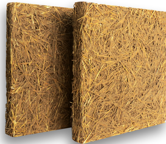
Probetas de relleno. Densidad: 277 kg/m 3 . Tamaño: 60 cm por 60 cm por 8 cm
