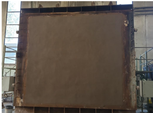
Imagen 1 - Aspecto de la cara expuesta de la muestra antes del comienzo del ensayo.
