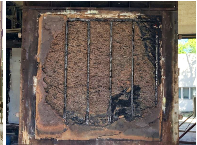
Cara expuesta al fuego una vez finalizado el ensayo.
