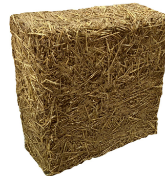
Bloque prefabricado de tierra alivianada con fibra vegetal (BTA).
