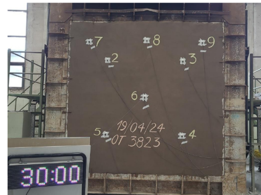
Imagen 4 - Aspecto de la muestra a los 30 minutos desde el comienzo del ensayo.
